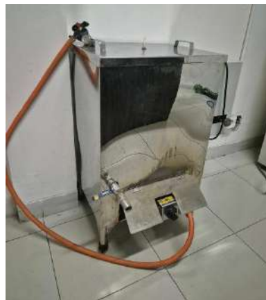
Gambar 2 Alat pemanas tipe uap basah konvensional ( single dan multi-tray )
