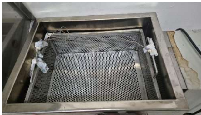
Gambar 3 Bagian dalam alat pemanas tipe uap basah konvensional ( single dan multi-tray )
